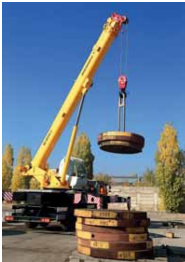
Рисунок. Процесс испытания крана тарированными грузами
