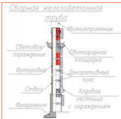
Рис. 2. Общий вид сборной железобетонной трубы
