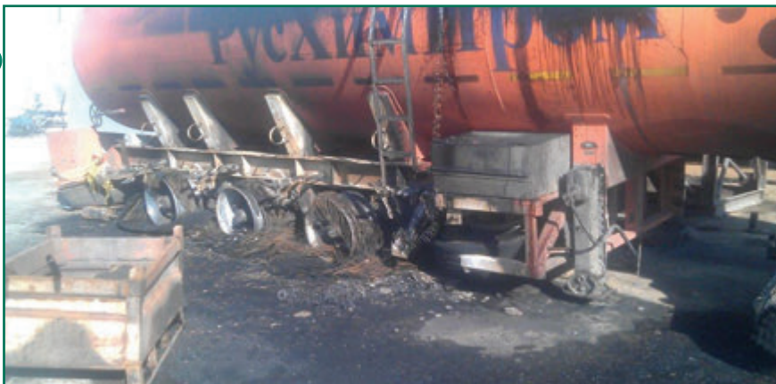
Рис. 3. Возгорание продукта при наливе в автоцистерну раствора нефтеполимерной смолы на предприятии ООО «РусХимПром»
