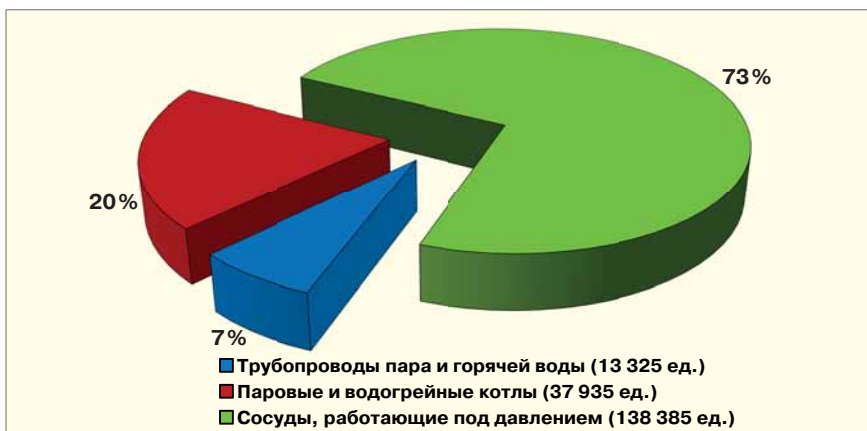
Рис. 4. Соотношение типов технических устройств, отработавших расчётный срок службы
