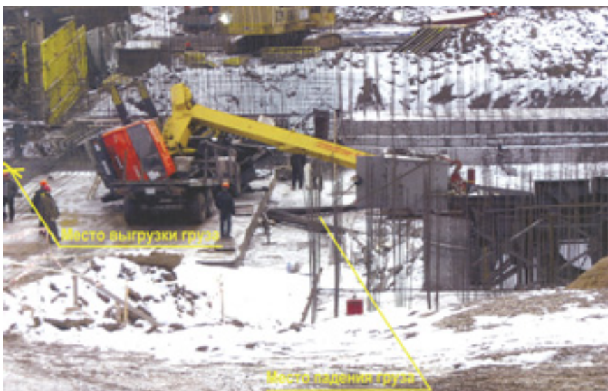
Рис. 4. Место аварии автомобильного крана КС- 45717-1 в ООО «Крупнопанельное домостроение Удомля-1»
