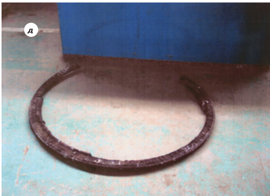
Рис. 1. Место выхода и возгорания нефти на 881-м км магистрального нефтепровода Куйбышев–Лисичанск (а); задвижка № 12 (б и в); корпус задвижки (г); вырванный из корпуса задвижки бурт (д)
