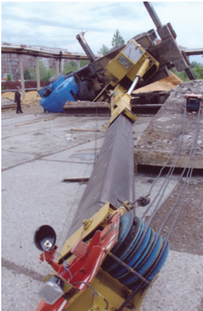
Рис. 4. Автомобильный кран KC-45721 после аварии (ООО «Кранмонтаж»)
