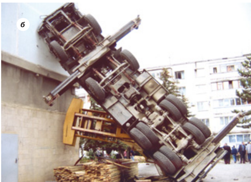
Рис. 6, а и б. Последствия аварии автомобильного крана КС-6476 в ООО «Ространс»
