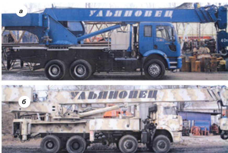
Рис. 1. Краны монтажные специальные на автомобилях: а – МКТ-40; б – МКТ-50
