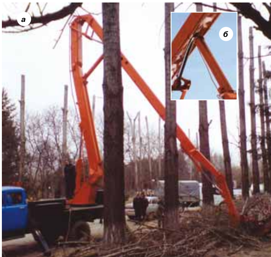
Рис. 3. Последствия аварии подъемника АГП-22.04 (а); гидроцилиндр подъема среднего колена стрелы подъемника после аварии (б)
