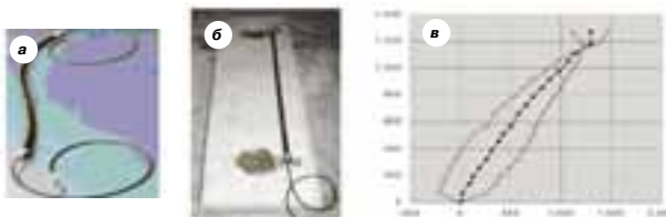
Рис. 6. Удлиненный датчик деформации бетона (а); применение датчика (б); результаты полевых испытаний (в)
