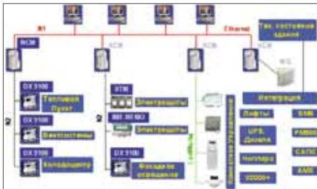
Рис. 7. Система управления зданием
