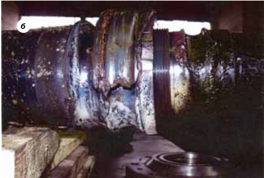
Рис. 4. Последствия аварии в ООО «Ставролен»: а – место возгорания насоса (вид сверху); б – расплавление шариков и скопление их в одном месте
