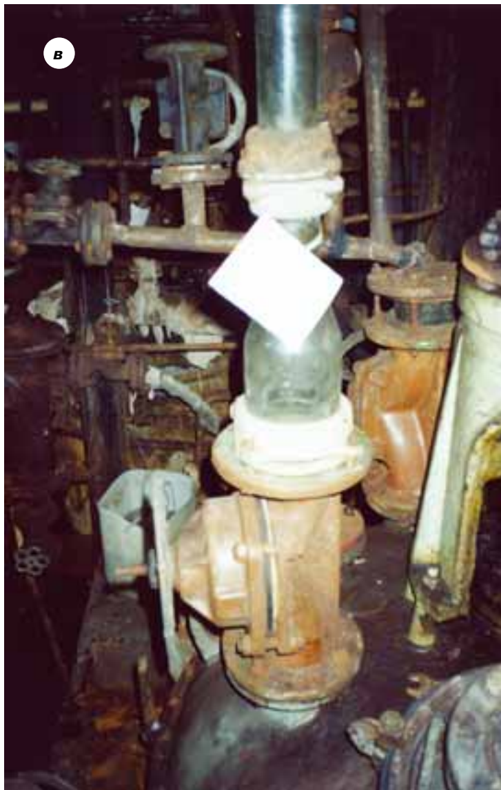
Рис 3. Место несчастного случая в ОАО «Усолье-Сибирский ХФЗ»: а и б – реактор производства унитиола; в – бромная воронка, через которую сероводород выделялся в помещение
