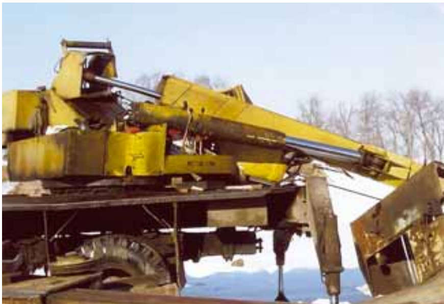
Рис. 1. Последствия аварии автомобильного крана KC-3577-3
