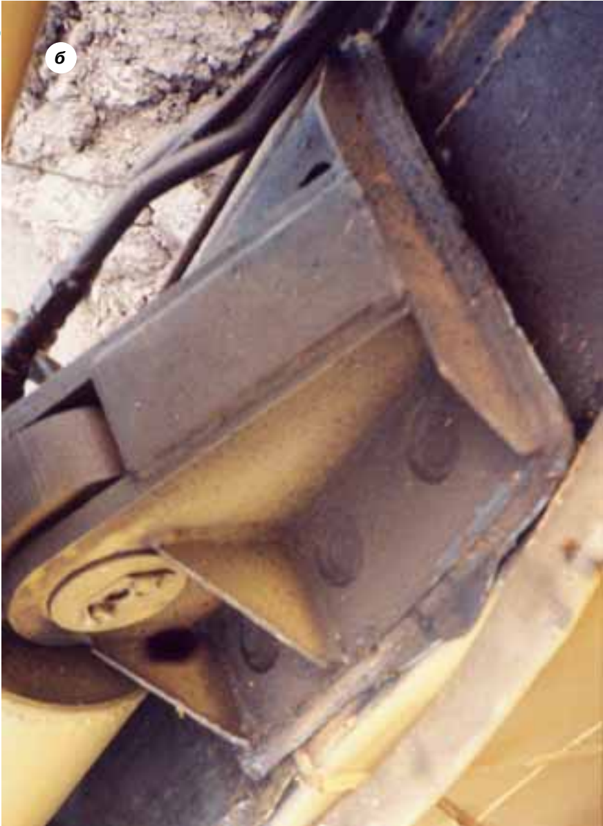
Рис. 4, а и б. Место аварии автомобильного подъемника ВС-28К (а) и разрушившийся узел гидроцилиндра подъемника (б)
