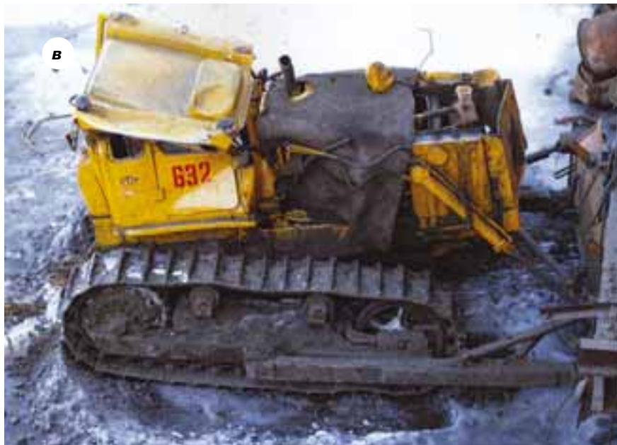
Рис. 1, а–в. Место аварии в ПООФ НГК «Талнахская обогатительная фабрика»: а – отметка разгрузочной площадки; б – траектория падения; в – бульдозер после опрокидывания (вид сверху)
