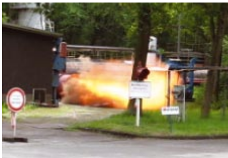
Свободное снятие давления с помощью мембраны с выбросом пламени
