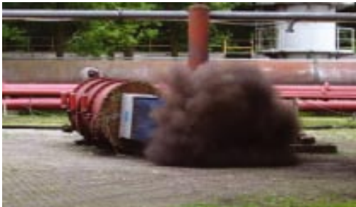
Беспламенное снятие взрывного давления с помощью Q-Vox
