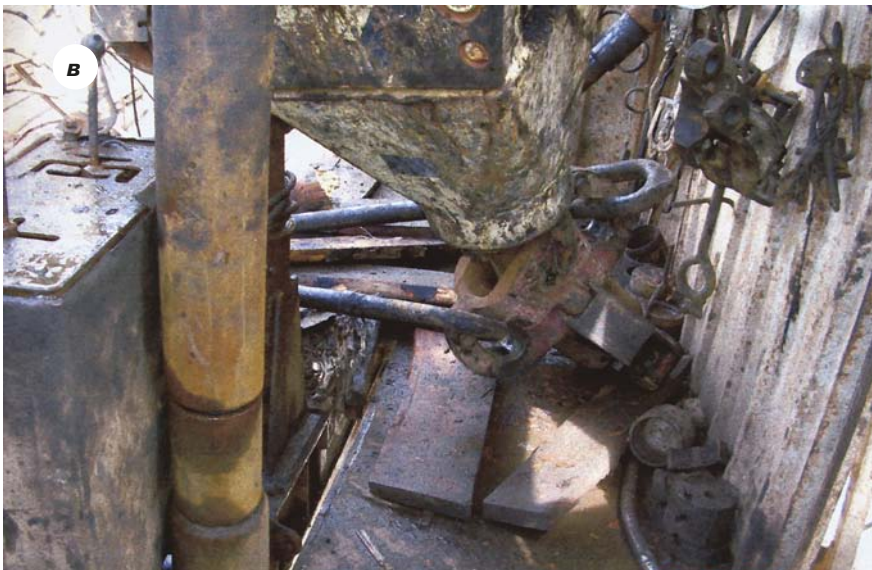
Рис. 2, а–в. Место аварии в ОАО «Альметьевское управление буровых работ» 04.07.05: а – упавшая верхняя телескопическая секция буровой установки; б и в – разрушения на буровой установке
