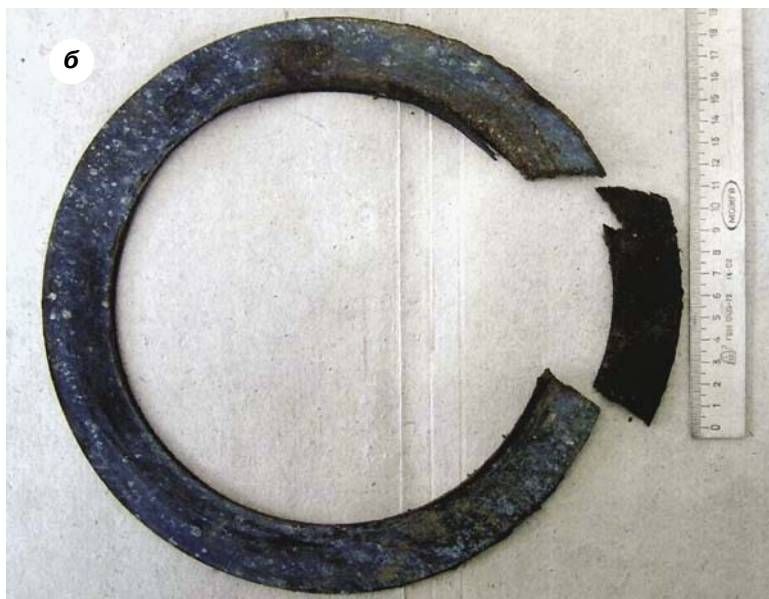
Рис. 8. Место аварии в ООО «Сургутгазпром»: а – фланцевое соединение задвижки со стороны перемычки между трубопроводами линии нагнетания насоса до аварии; б – паронитовая прокладка с оторвавшимся сегментом
