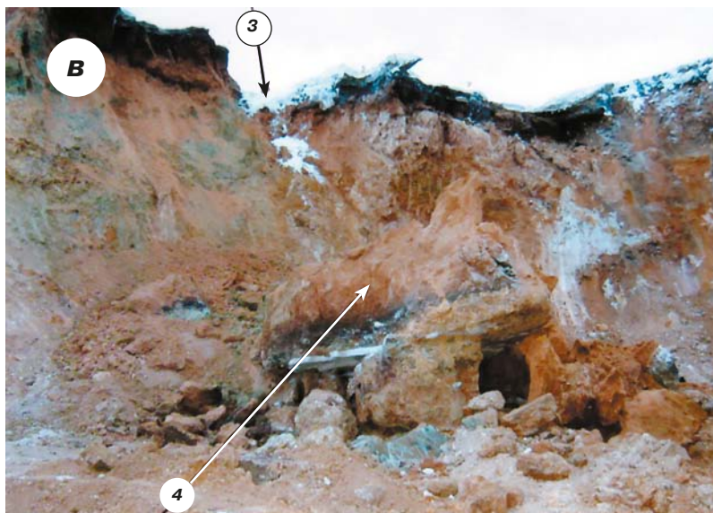
Рис. 10, а – в. Последствия несчастного случая в ЗАО «ОРМЕТ». 1 – кабина экскаватора; 2 – рука пострадавшего; 3 – место вывала; 4 – место нахождения глыбы после буксировки экскаватора.
